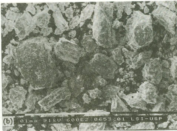
Figura 5 - Micrografias eletrônicas de varredura dos pós de Al -325# (a) e de Nb -325# (b).
