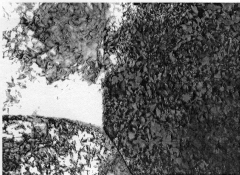
Figura 4.21: Microestrutura típica, observadas por microscopia eletrônica de transmissão, das amostras da liga M-1 (Fe-30Al-0,15Zr-0,2B sem cromo) no estado laminado a quente.
