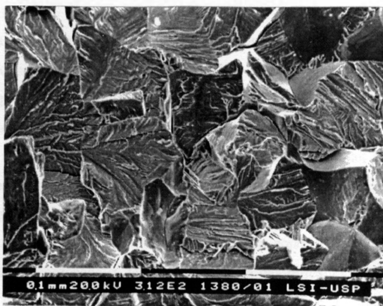
Figura 4.4: Superfície de fratura típica dos corpos de prova da liga Fe-24Al-2Cr (%at.) tratada termicamente na condição TT1 e ensaiados em tração a temperatura ambiente.
