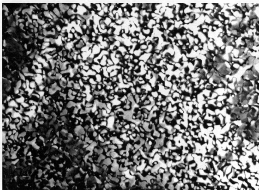
Figura 4.24: Micrografia típica da liga M-1 (Fe-30Al-0,15Zr-0,2B sem cromo), tratada termicamente a 500 °C / 1 h, observada em campo escuro a partir da reflexão (111) do ordenado \text{D0}_3 .
