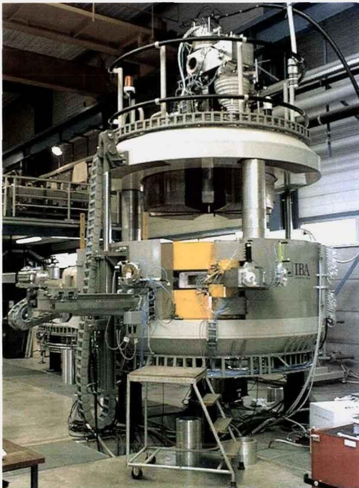
Figura 3.6: Cyclone 30 instalado no IPEN-CNEN/SP, quando ainda estava nas dependências da fábrica da IBA , na Bélgica.
