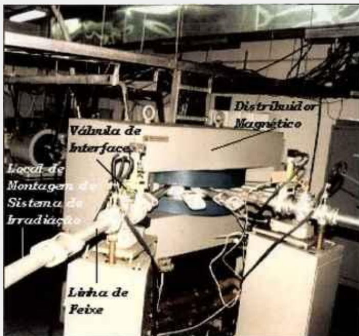
Figura 3.8: Distribuidor Magnético, Linhas de Feixe e Local onde foram montados os Sistemas de Irradiação do Cíclotron CV-28 do IPEN-CNEN/SP.
