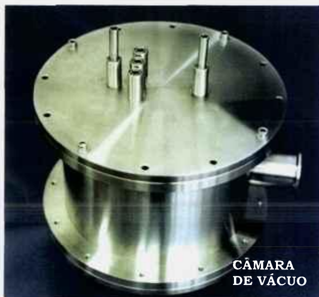
Figura 4.4: Porta-alvo Líquido (Criogênico) confeccionado.
