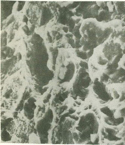
FIG.3-Liga sem Nb, 25% deforma- ção- 29 envelhecimento 160°C, 14 horas - 1000X
