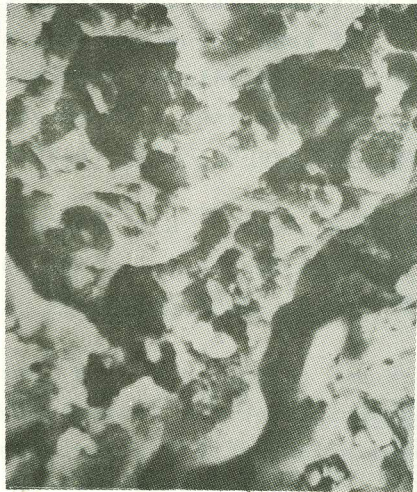
FIG.4-Liga com Nb - 10% deforma- ção - 29 envelhecimento 160°C, 14 horas - 1000X
