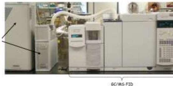
Figura 3: Sistema de desorción acoplado a un GC/MS/FID.
