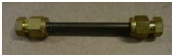
Figura 2: Tubos de metal que contienen Tenax y carbón activado
