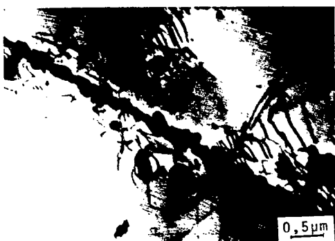
Figura 6: Liga EMVAC 600 nacional, laminada (90% redução em espessura), solubilizada e envelhecida a 720°C por 10 horas micrografia eletrônica (MET), onde observa-se intensa precipitação no contornos de grão e em seu interior.
