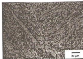
Fig. 9 - Micrografia do cordão de solda obtido por laser pulsado Nd:YAG, com Lt = 4 ms e f = -2 mm
