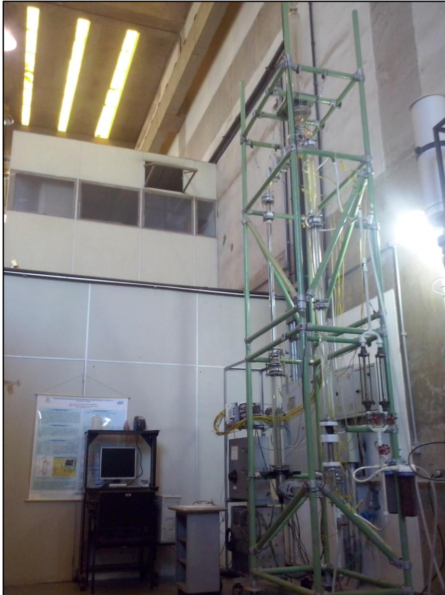
Figura 2: Foto da remontagem do Circuito de Circulação Natural.
