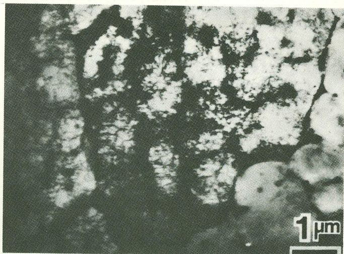
Fig. 8 – Microestrutura da liga de alumínio 7050 SR, metalografia eletrônica, arranjo "celular" onde pode-se observar a baixa densidade de precipitados no interior, a precipitação se dá preferencialmente nos contornos.
