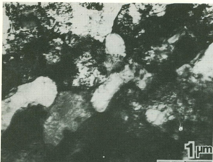
Fig. 5 – Microestrutura da liga Al-9%Mg SR, metalografia eletrônica, grãos contendo rede de discordâncias com pouca precipitação presente.
