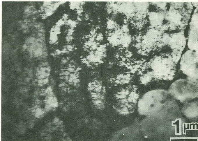
Fig. 2 – Microestrutura da liga de alumínio 3003 SR, metalografia eletrônica, arranjo celular/subgrãos onde a precipitação ocorre junto às paredes celulares.
