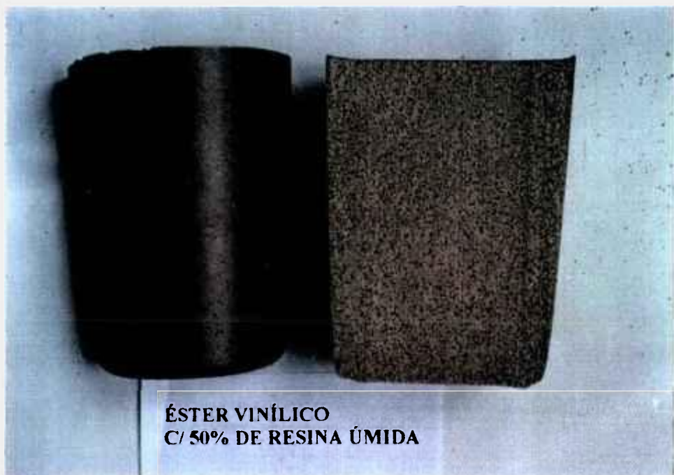
Figura 7: Matriz do éster-vinílico com 50% em peso de resina de troca iônica úmida.
