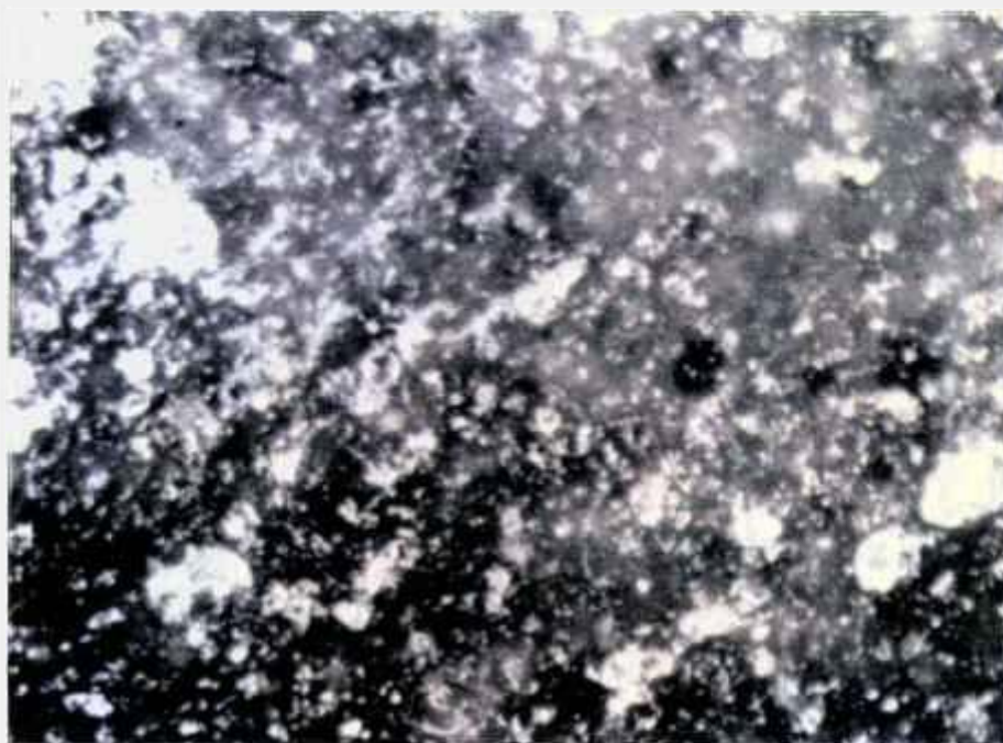
Figura 10: Mistura homogênea da matriz polietileno com as resinas de troca iônica.
