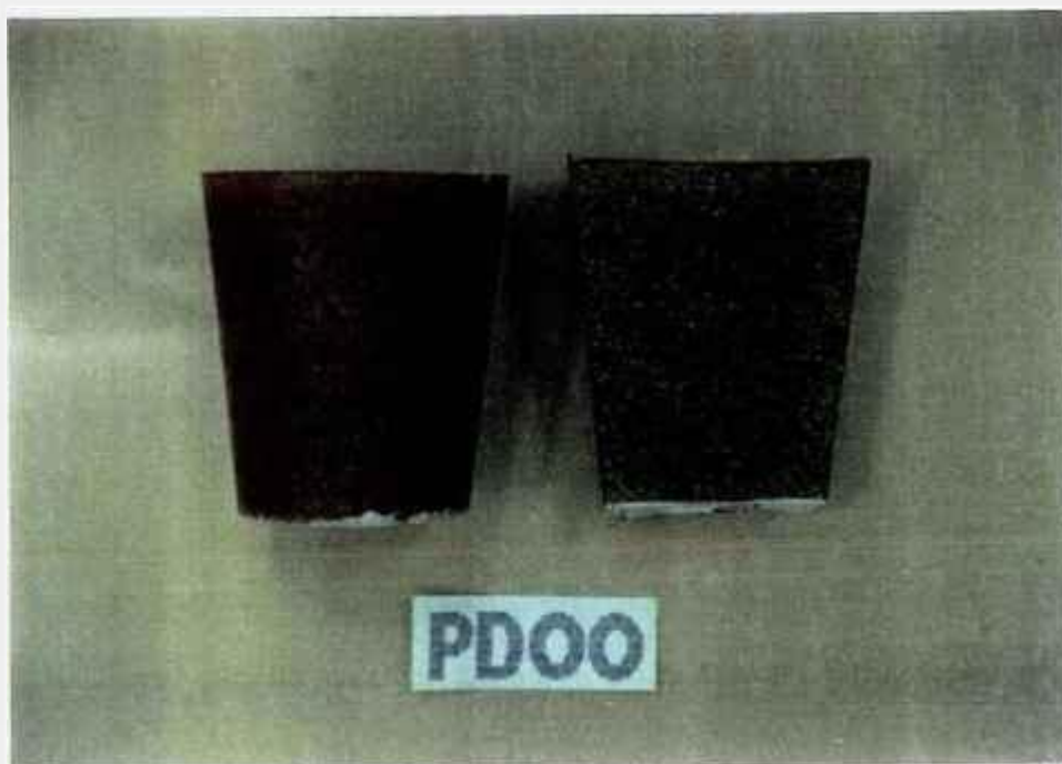
Figura 4: Matriz de epoxi com 50% em peso de resina de troca iônica seca.
