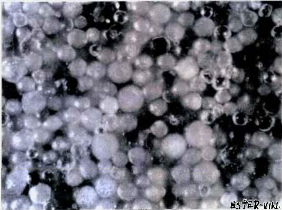
Figura 12: Mistura homogênea do éster-vinílico com resinas de troca iônica.
