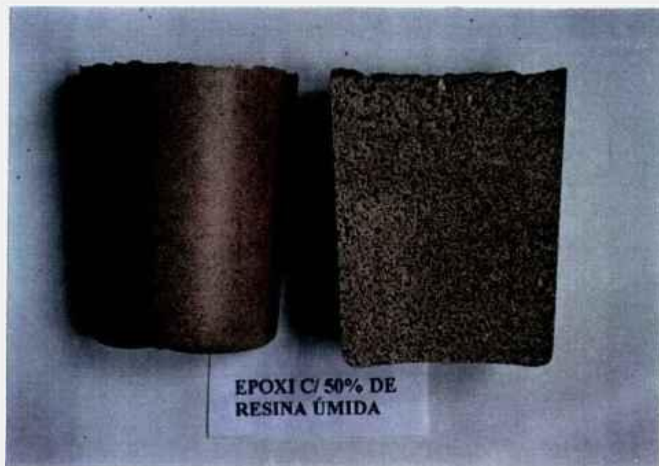
Figura 3: Matriz de epoxi com 50% em peso de resina de troca iônica úmida.
