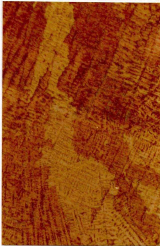
Figura 4.21 . Microestrutura mostrando a mudança de direção de crescimento colunar, devido ao deslocamento da interface sólido líquido.
