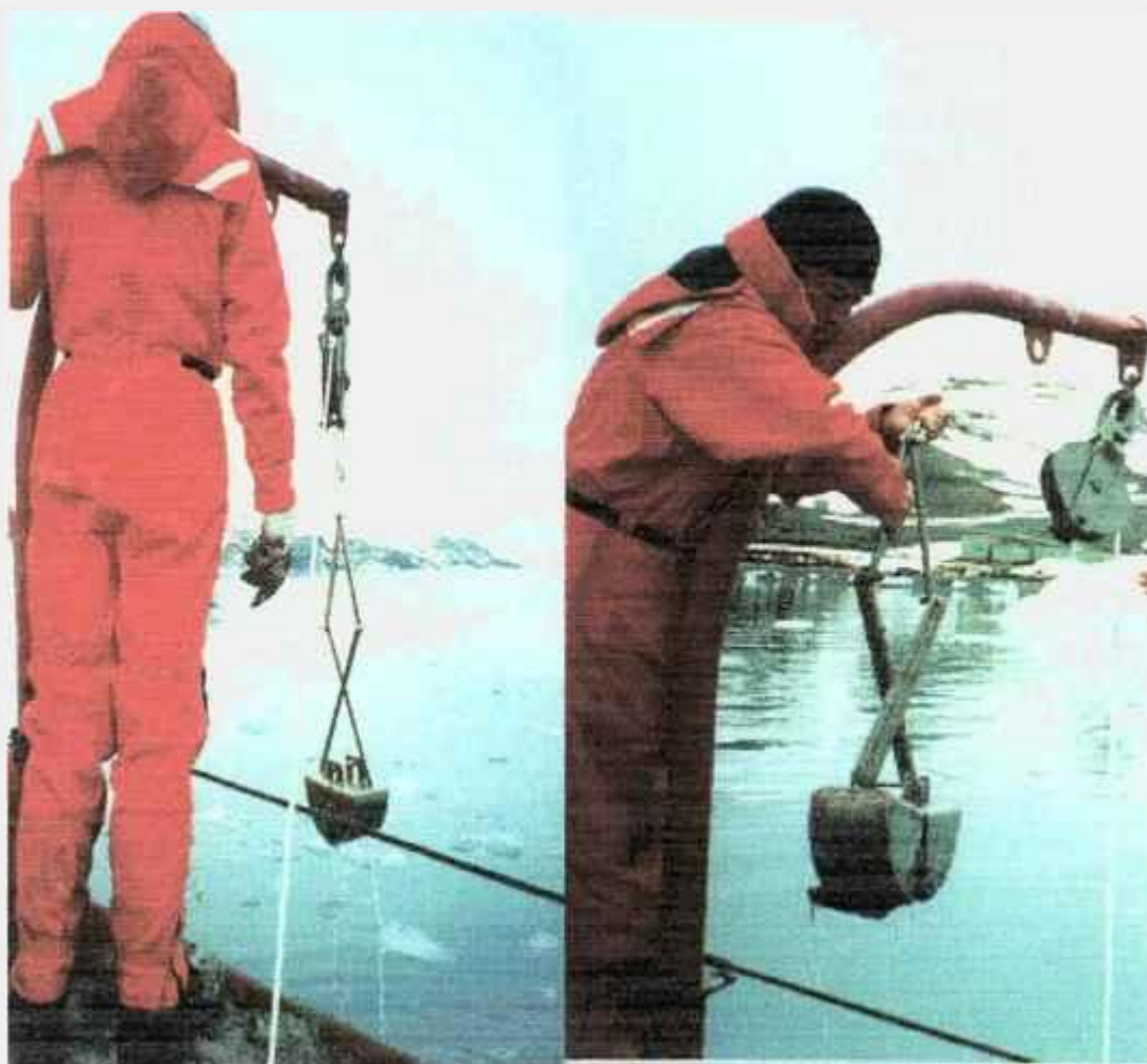
Figura 17. Coletas de sedimentos marinhos utilizando um pegador de fundo inóx (van-veen).
