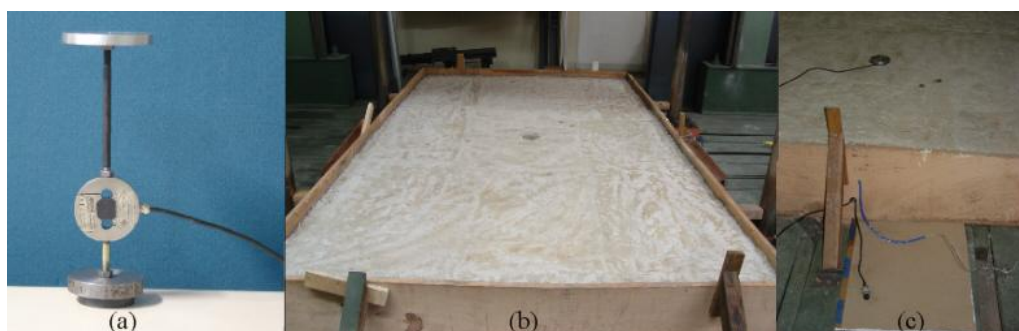
Figura 5 – (a) célula de carga com base magnética para fixação no piso da laje de reação, (b) base com a cavidade de abrigo (poço) da célula de carga, (c) célula de carga posicionada dentro da cavidade.
