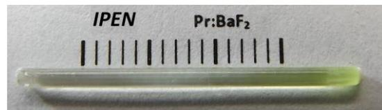
Figura 2: Fibra monocristalina de  $\text{BaF}_2$ : (a) pura e (b) dopada com Pr.
