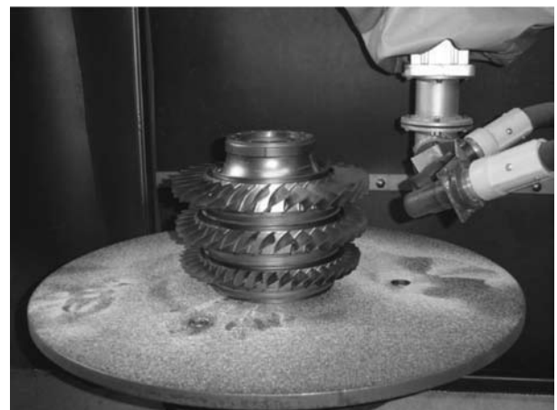
Figura 2. Exemplo de aplicação do processo de jateamento com granalha [7].
