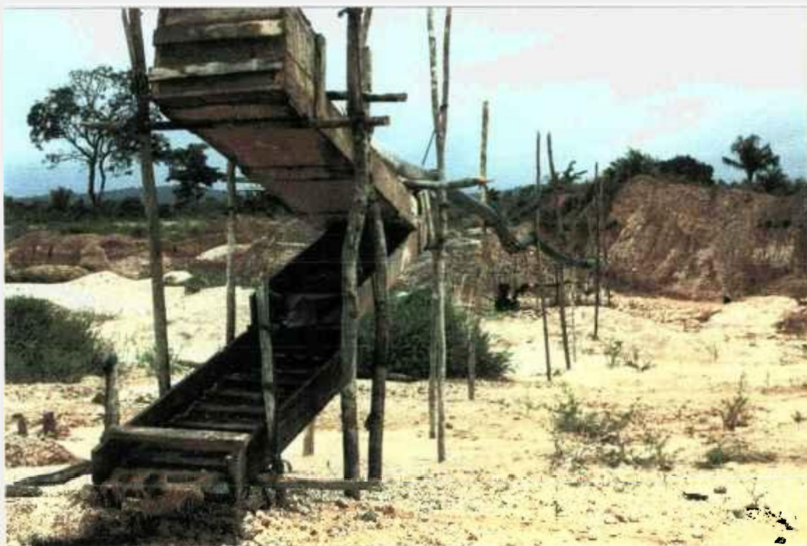
Figura 05. Calhas acarpetadas utilizadas no processo de amalgamação do ouro com mercúrio na bacia do rio Vila Nova, Amapá, Brasil
