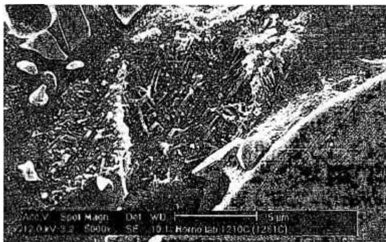
Figura 2.6: Micrografia eletrônica de varredura da superfície de fratura da composição padrão sinterizada a 1190°C atacada quimicamente com ácido fluorídrico 33 .
