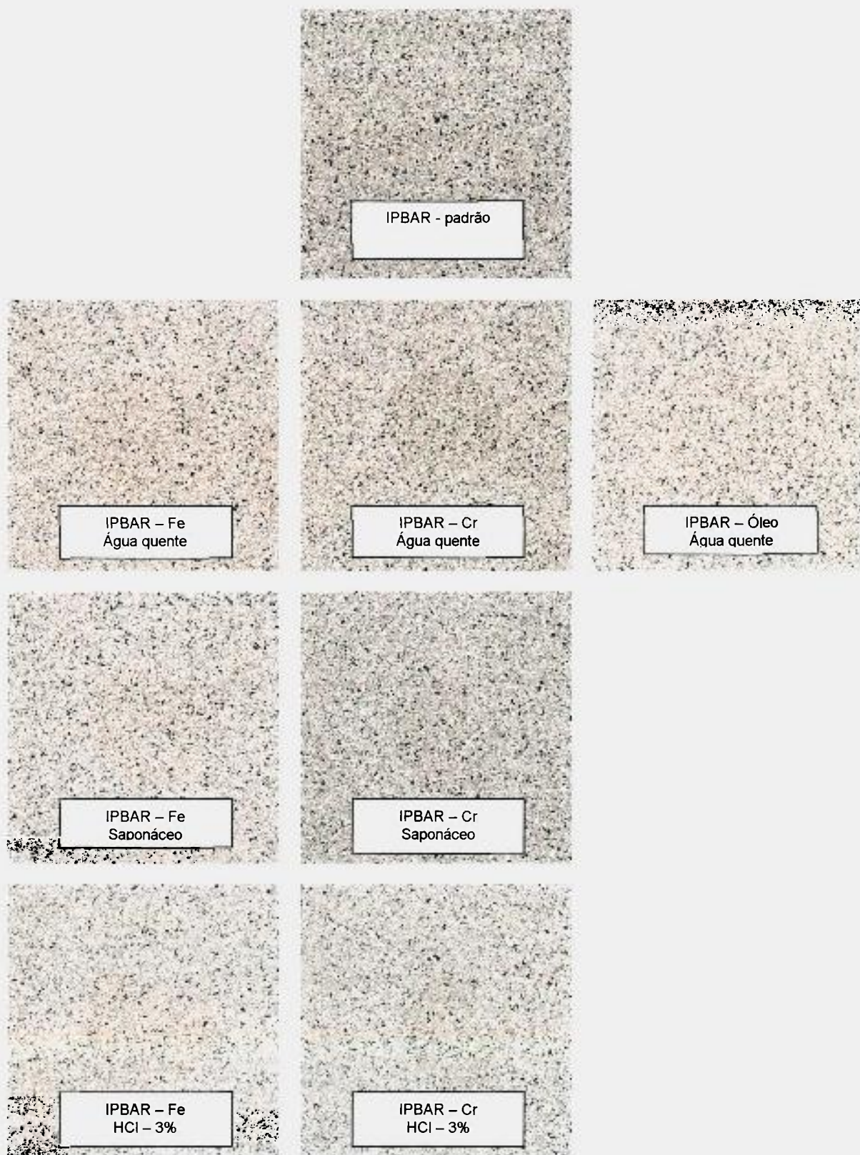
Figura 5.5: Aspecto da superfície das amostras IPBAR após o ensaio de manchas em diferentes etapas de limpeza.
