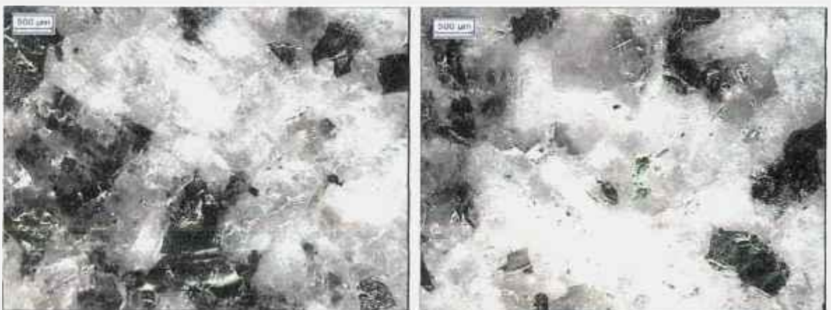
Figura 5.38: Análise de imagem da superfície do granito GCINZ manchada com óxido de cromo.
