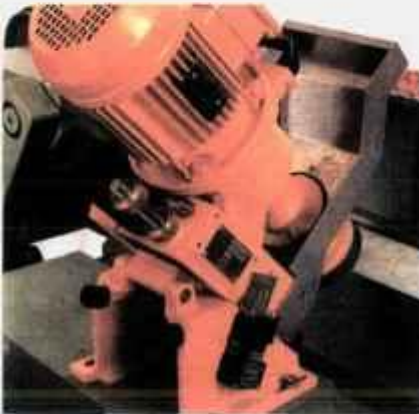
Figura 2.19: Equipamentos para retífica dos lados das peças, visando a eliminação de rebarbas e o ajuste da ortogonalidade dos produtos 16 .
