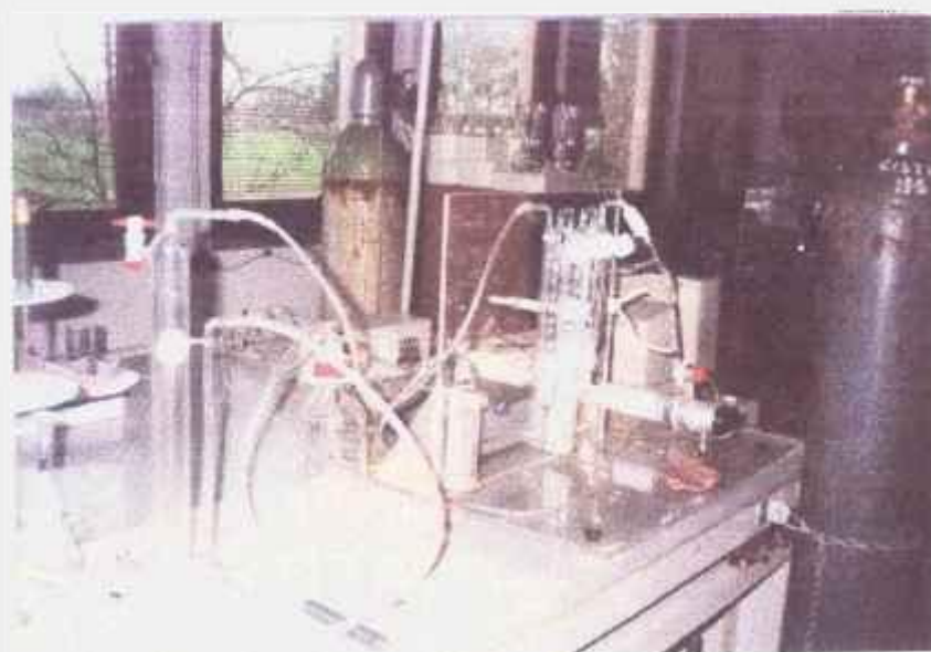
Figura 3.1 – Equipamento de CV-AAS (absorção atômica acoplada a um sistema de geração de vapor frio).
